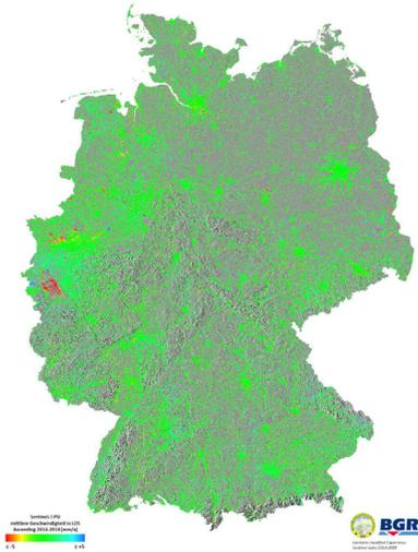
Die Abbildung zeigt eine bundesweite Karte der Oberflächendeformation basierend auf Copernicus Sentinel-1-Daten nach der Persistent Scatterer Interferometrie (PSI) Methodik prozessiert.
