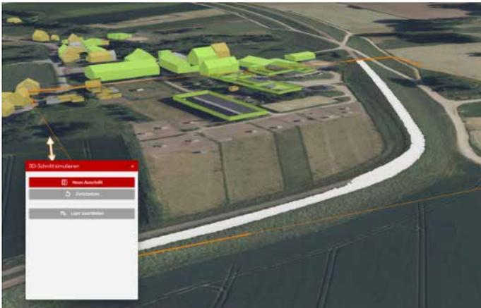
▲ Abbildung 5: Analyse von Objekten gleicher Höhe hier am Beispiel eines Deiches
